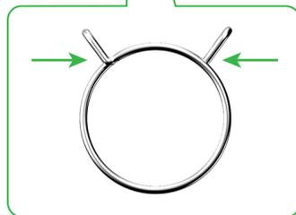
■ Utilice la brida del tubo para sostener el tubo de escape de humo
